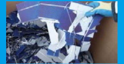
壊れたPVモジュールの分別収集
