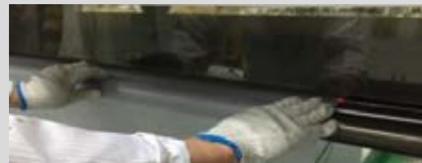
改善後、パネルの追加により、手がローラーに届くことを防止
