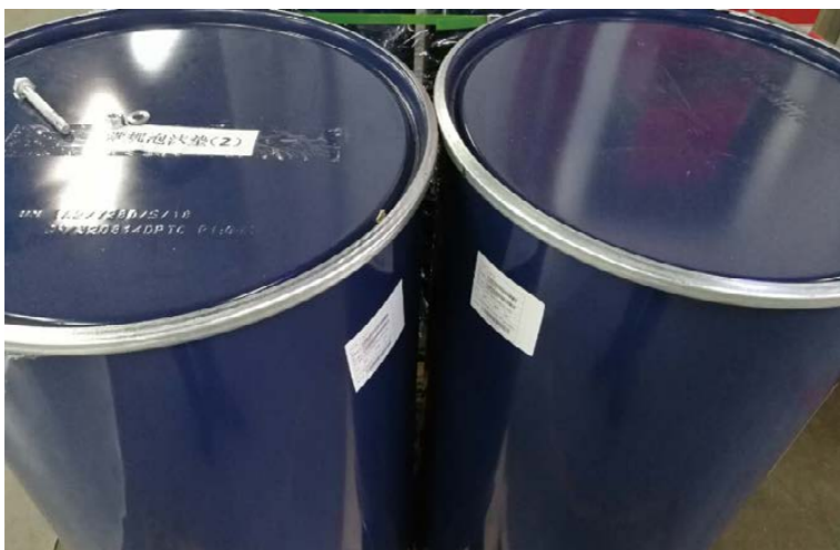
两桶硅胶桶桶盖接触点存在夹伤员工手指风险
