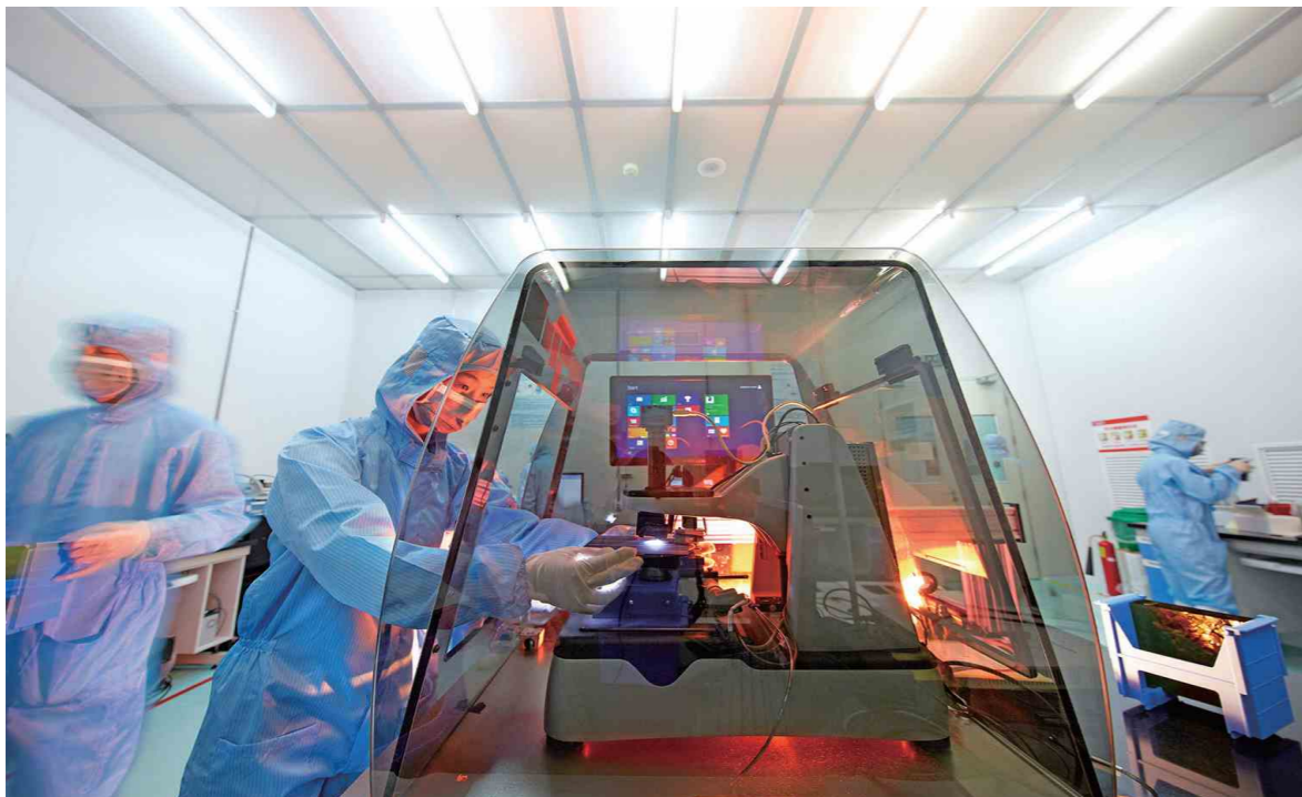
科研人员进行金属栅线形貌测试
