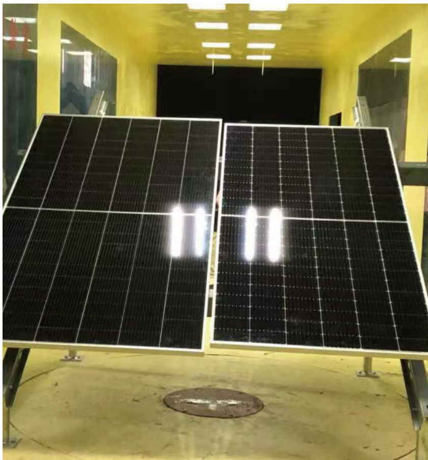
备注:测试的极限值并不意味着实际情况只有达到极限值才会出现失效,还需考虑当地的风振系数、脉冲风、场地类别、局部体型系数的转换等实际参数,因此在远小于59米/秒内也有可能失效。
