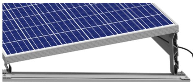
3. 用压块固定前后支脚，然后锁紧 4 个支脚的螺母。
