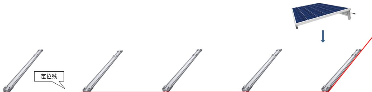
2. 将组件横放，使其短边框与龙骨方向齐平。组件两短边框旁各有一根龙骨，选择两根龙骨相对的滑槽，将组件的前后支脚插入相应长龙骨的滑槽内。
