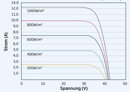
**P-V KURVEN DES PV-MODULS (415 W)**
