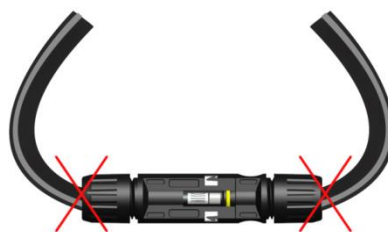
Passage de câble incorrect
