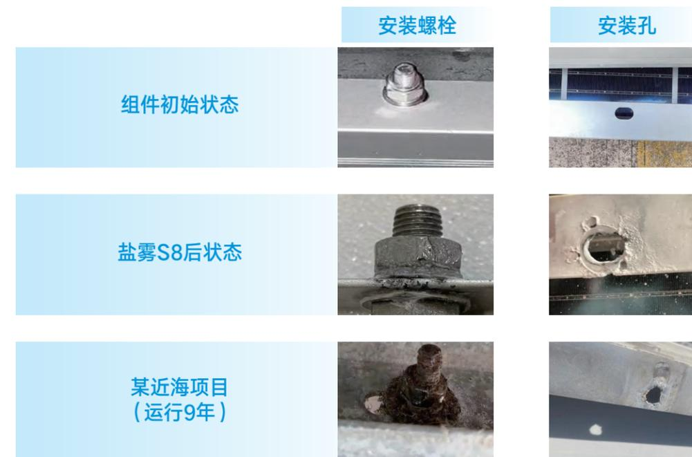
海上光伏应重点关注边框--螺栓连接位置的电化学腐蚀问题，从以下两方面解决：
