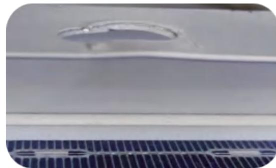
针对海洋环境大风天气带来的边框撕裂和螺栓松动问题，在以下两方面进行加强：
