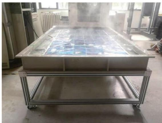
PID测试设备（60℃、75℃、85℃，3.5%盐水浸泡PID）
