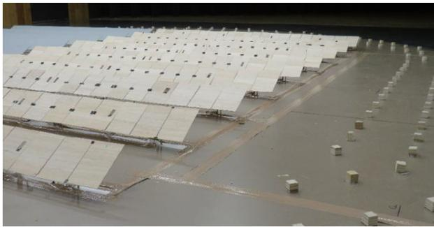
图 31：全气动弹性模型试验的模型
