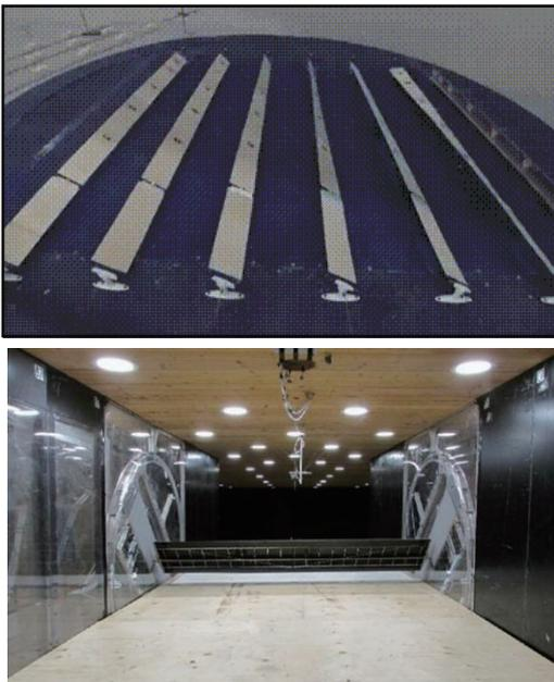
图 27： 二维截面模型测试的模型
