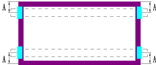
Utilice 4 abrazaderas en el lado corto. Los carriles de montaje discurren paralelos al marco lateral largo.
