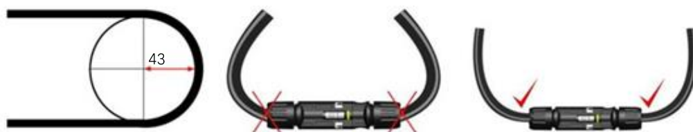
图5. 电缆的最小弯曲半径。
