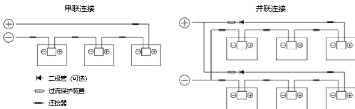
图5. 串联连接和并联连接。
