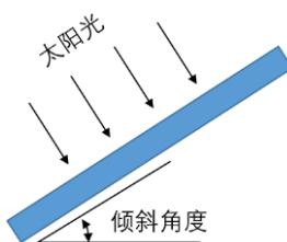
光伏组件的倾角是指光伏组件和水平地面之间的夹角。不同的项目因地制宜选择不同的安装倾角，天合推荐组件的倾角不小于10°，具体倾角选择可依据当地所执行的设计规程、规范、法规或遵循光伏组件安装商的建议。
