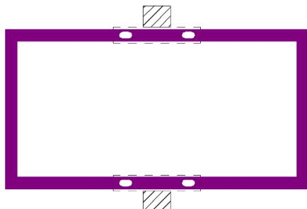
转轴垂直于长边 同侧安装孔间距400mm
