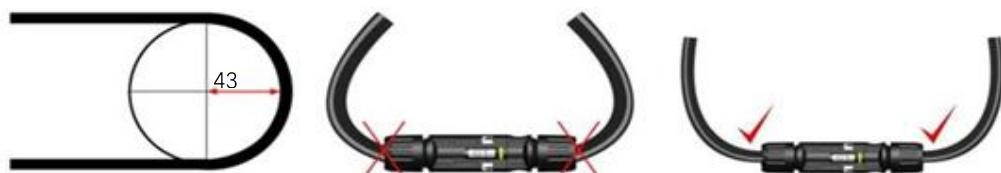
图4. 电缆的最小弯曲半径。
