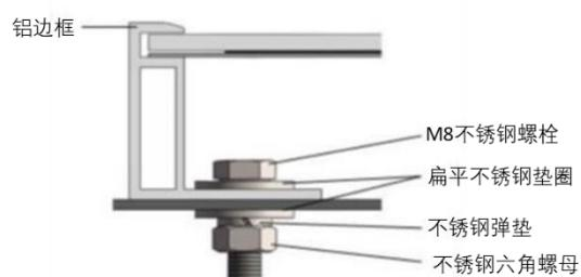
图1：使用螺栓嵌入法安装的光伏组件。
