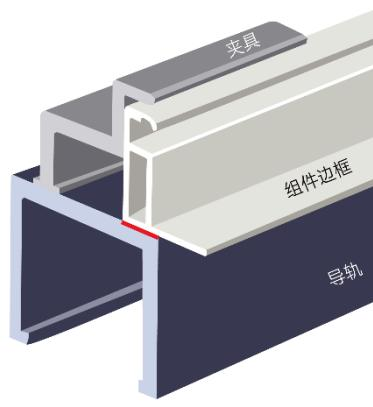
— 导轨与组件边框重叠面 $\geq 20\text{mm}$
