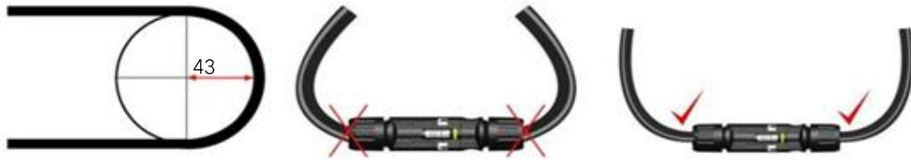
图4. 电缆的最小弯曲半径。
