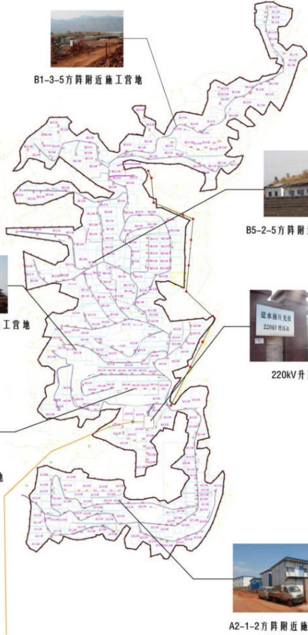
附图二 项目光伏方阵平面布局及施工营地布设图
