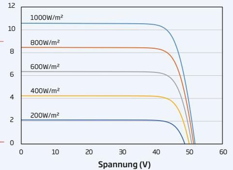
**P-V KURVEN DES PV-MODULS (440 W)**
