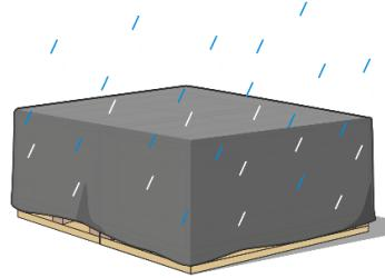
禁止托盘泡水，存放地应先做好地面排水措施，防止雨后地面大量积水引起地面松软、下沉等现象。
