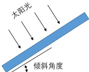
光伏组件的倾角是指光伏组件和水平地面之间的夹角。不同的项目因地制宜选择不同的安装倾角，天合推荐组件的倾角不小于10°，具体倾角选择可依据当地所执行的设计规程、规范、法规或遵循光伏组件安装商的建议。
