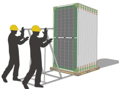
4.将拆箱靠架从组件玻璃面或背板面插入托盘底部
