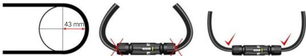
图5. 电缆的最小弯曲半径。
