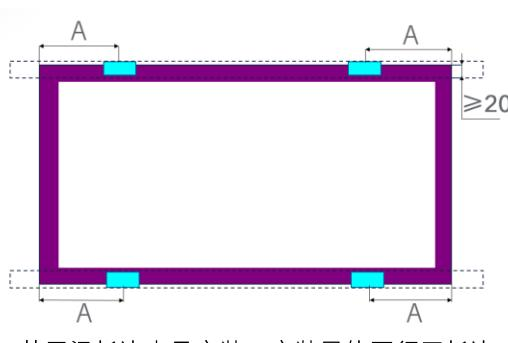
共用梁长边夹具安装，安装导轨平行于长边
