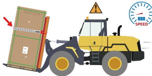
叉车运输时将包装箱倾斜抵靠在叉车门架上，必须用抗拉强度 $\geq 2000\text{kgf}$  的安全绳将组件固定在叉车上，并控制速度，以防止倾倒。
