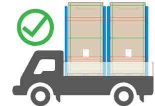
箱式及非箱式货车运输组件时，托盘与托盘之间要紧密摆放不留空隙，车厢尾部空位需进行填充加固，预防运输中组件向车尾部移动。当使用非箱式货车运输时，每托组件都需要用绳索与运输车辆进行固定。
