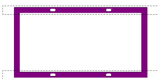
安装导轨垂直于长边 (安装导轨与组件背面保持适当的间隙)
