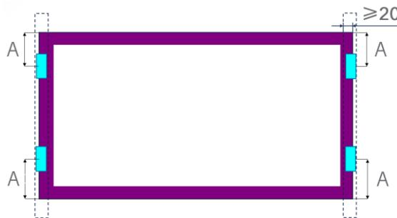
共用梁短边夹具安装，安装导轨垂直于长边
