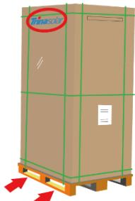
货叉从托盘长边方向缓慢进入托盘底板和面板之间，不要碰撞组件，门架两侧同时靠紧托盘。
