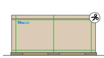
1 剪断外部打包带并去除缠绕膜
