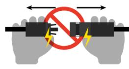
禁止用力拉扯、划伤或弯曲输出电缆，否则电缆的绝缘部分会被损坏导致漏电或触电。
